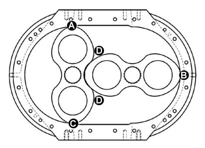
Fig. 12 Impeller Clearances
